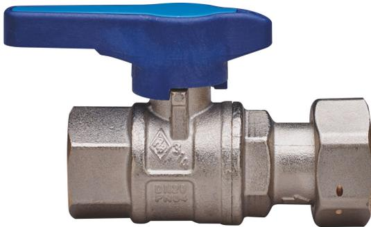
Kugelhahn für den Eingang des Trinkwasserzählers, voller Durchgang, einerseits Innengewinde, andererseits Überwurfmutter, Griff aus Technopolymer, Kugel mit automatischer Hinterspülung.
