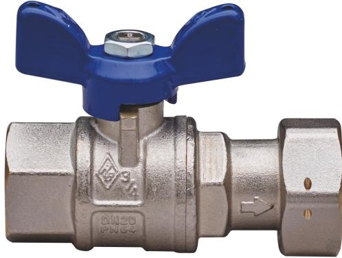
Kugelhahn für den Eingang des Trinkwasserzählers, voller Durchgang, einerseits Innengewinde, andererseits Überwurfmutter, Aluminium Flügelgriff, Kugel mit automatischer Hinterspülung.
