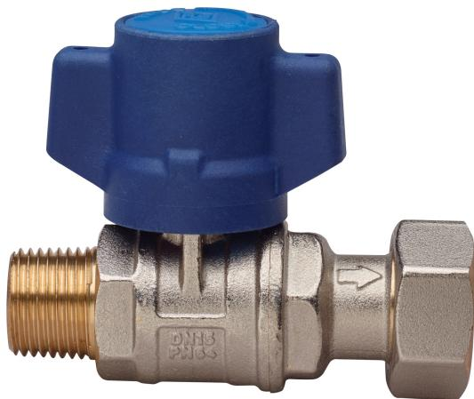
Kugelhahn für Wasserzähleranschluss, mit vollem Durchgang, Außengewinde/Gewindeverschraubung, mit eingebautem Rückschlagventil, mit manipulationssicherem Flügelgriff und Edelstahl Sicherheitsmutter, Kugel mit automatischem Spülsystem.
