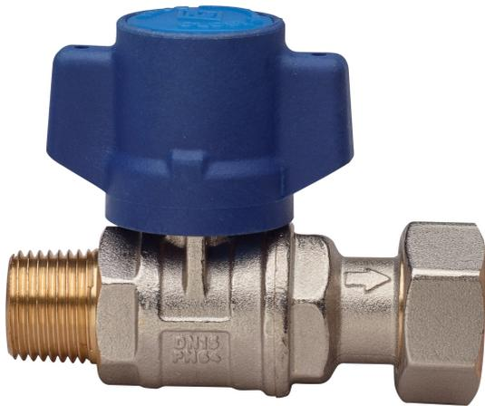
Kugelhahn für den Eingang des Trinkwasserzählers, voller Durchgang, einerseits Aussengewinde, andererseits Überwurfmutter, mit **narrensicherem** Flügelgriff und Kugel mit automatischer Hinterspülung.
