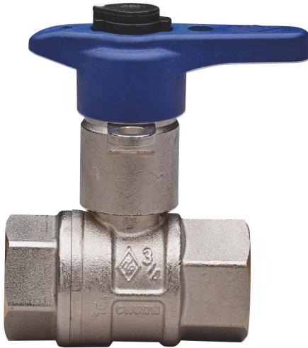
Kugelhahn für Trinkwasser, voller Durchgang, beiderseits Innengewinde, mit Griff aus technopolymer mit verriegelbarem und austauschbarem Schloss, Kugel mit automatischer Hinterspülung.
