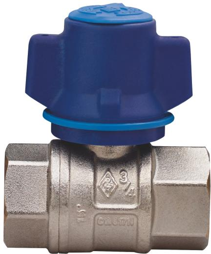
Kugelhahn für Wasserzähleranschluss, mit vollem Durchgang, I/I Gewinde, mit **manipulationssicherem** Flügelgriff und **Siebenkant Sicherheitsmutter aus Edelstahl**, Kugel mit automatischem Spülsystem.
