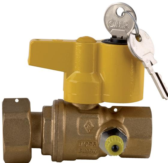
Kugelhahn mit vollem Durchgang, Montage mit Zähler, mit Sicherheitsanschluss für Druckmessung, Anschlussmutter 1", Innengewinde und Sicherheitsverschluss.
