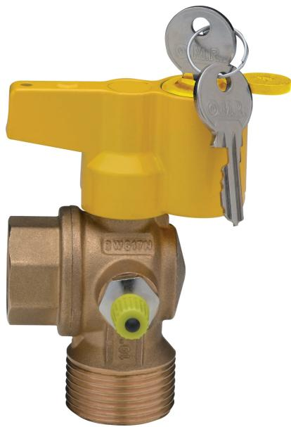
Eck-Kugelhahn voller Durchgang, Montage nach dem Zähler, mit Sicherheitsanschluss für Druckmessung, einerseits Innengewinde, andererseits Aussengewinde, mit Flügelgriff.
