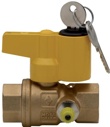
Kugelhahn voller Durchgang, Montage nach dem Zähler, mit Anschluss für Druckmessung, beiderseits Innengewinde, mit Flügelgriff.
