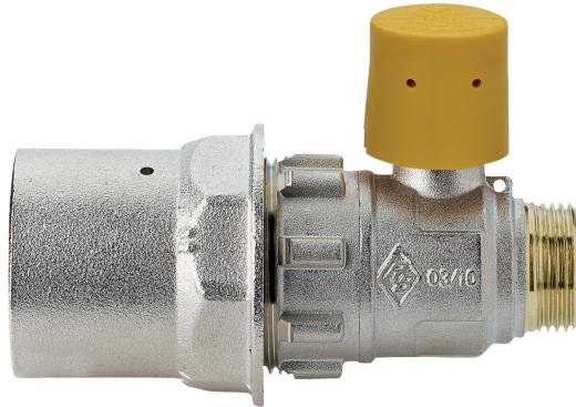
Kugelhahn mit vollem Durchgang für Gasrohrleitung, Versiegelungskappe, Außengewinde und PE Anschluss, mit Anschluss für Schutzrohr aus Stahl.
