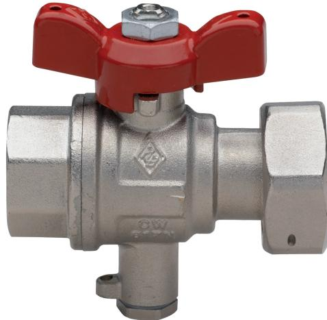
Kugelhahn voller Durchgang, mit Sondenanschluss für Wärmemessung, einerseits Innengewinde, andererseits Überwurfmutter, mit Aluminium Flügelgriff.
