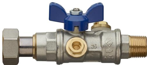
Kugelhahn für den Ausgang des Trinkwassermessers, voller Durchgang, einerseits Innengewinde, andererseits Überwurfmutter, mit integriertem **grossem** Rückschlagventil und Druckmessanschluss, Aluminium Flügelgriff und Kugel mit automatischer Hinterspülung.
