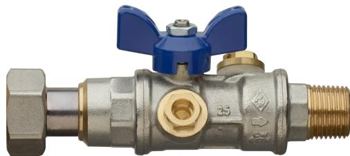
Kugelhahn für den Ausgang des Trinkwassermesszählers, voller Durchgang, einerseits Innengewinde, andererseits Überwurfmutter, mit integriertem **grossem** Rückschlagventil und Druckmessanschluss, Aluminium Flügelgriff und Kugel mit automatischer Hinterspülung.
