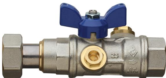
Kugelhahn für den Ausgang des Trinkwassermesszählers, voller Durchgang, einerseits Innengewinde, andererseits Überwurfmutter, mit integriertem **grossem** Rückschlagventil und Druckmessanschluss, Aluminium Flügelgriff und Kugel mit automatischer Hinterspülung.
