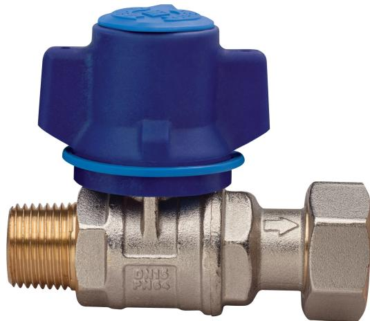
Kugelhahn für Wasserzähleranschluss, mit vollem Durchgang, Außengewinde/Gewindeverschraubung, mit **manipulationssicherem** Flügelgriff und **Edelstahl Sicherheitsmutter**, Kugel mit automatischem Spülsystem.
