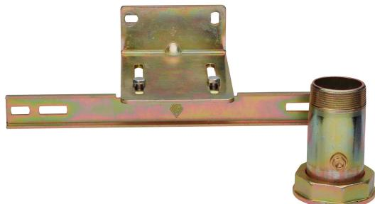
Stahlbalken, mit Gewindeanschluss nach UNI EN 10226-1 und Anschluss nach UNI ISO 228/1 G 1/4" für Druckmessung, justierbare Anbaublatte für Zähler G10-G16-G25.
