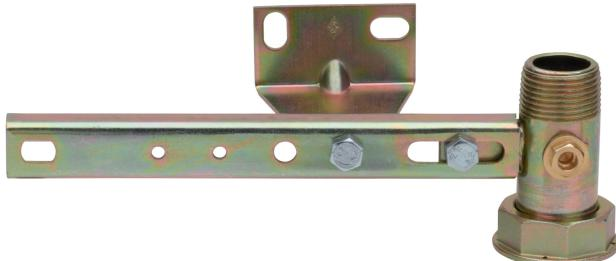
Stahlbalken, Achsenabstand 250 mm, mit Gewindeanschluss EN 10226-1 und Anschluss für Druckmessung, mit dreieckiger Anbauplatte für Dübel.
