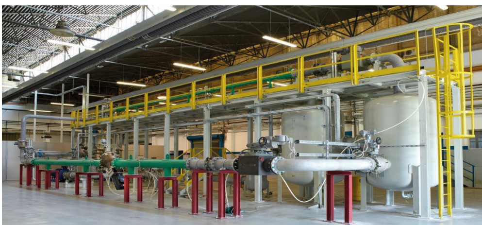
Flowtest Valpres con valvola a recupero energetico LOCPOWER durante una prova di collaudo.
